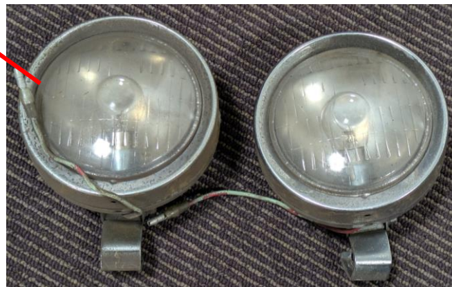
軌道モーターカーから 取替済みのライト
