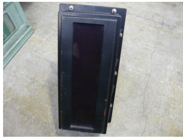
踏切故障表示機
