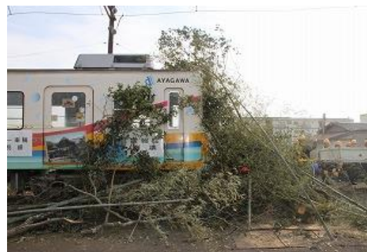
土砂流入による車両脱線
